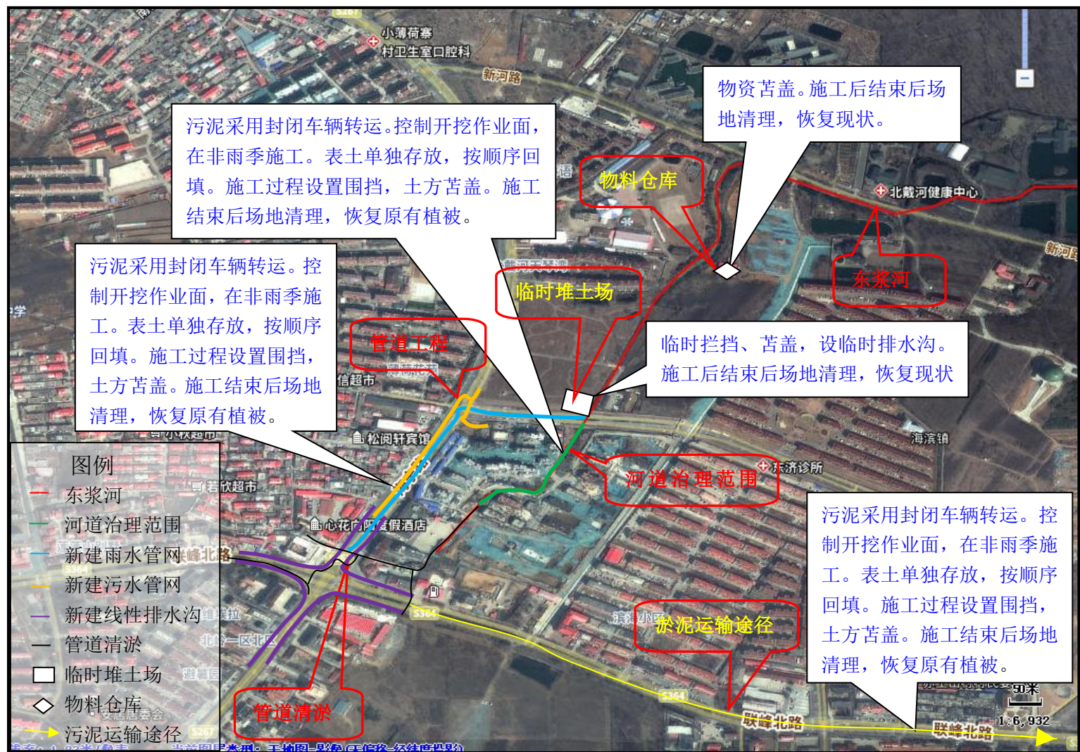
附图5 主要生态保护措施设计图 比例尺 1:6932
